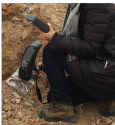
Можно с легкостью выполнять анализ крупногабаритных образцов, например, длинных буровых кернов, стенок ям и крупных кусков материалов, без необходимости перемещения образца.
